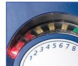
La LED iluminada permanecerá encendida sin necesidad de mantener pulsado ningún botón hasta que el medidor se apague. El medidor se apaga automáticamente 20 o 30 segundos después de la última vez que se haya pulsado cualquier botón.
